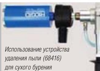
Использование устройства удаления пыли (68416) для сухого бурения
