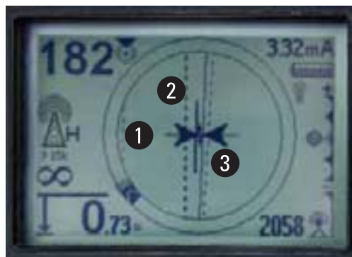
Экран в режиме OmniSeek: Отображаются несколько линий (на фотографии показаны три разные коммуникации) 1, 2, 3
