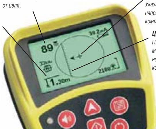
Экран в режиме OmniSeek: Отображаются несколько линий (на фотографии показаны три разные коммуникации) 1, 2, 3
